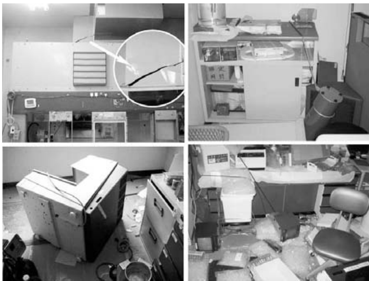
図5 PET関連の被害。ホットセルの排気ダクト(左上)。ドーズキャリブレータ(右上)。オートガンマ装置(左下)。落下物が散乱した測定室(右下)。
