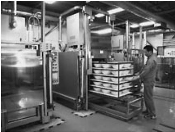
図1 大型電気炉を用いた試料の灰化
